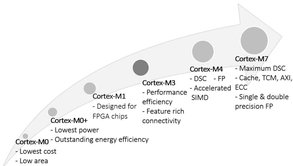
Fig. 2 : ARM Cortex-M cores M3.
