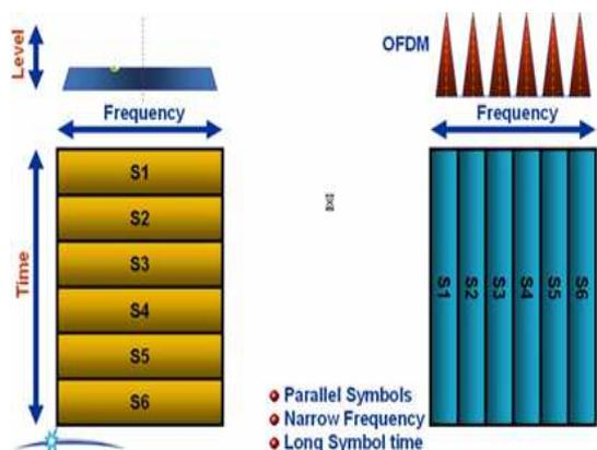
Fig. 2: FDM Vs.OFDM
