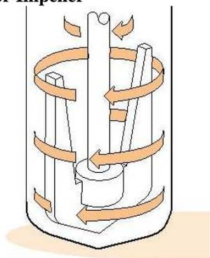
Fig. 2: Anchor Impeller
