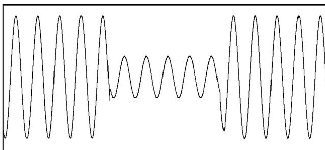
Fig. 2. Voltage Sag/Dip
